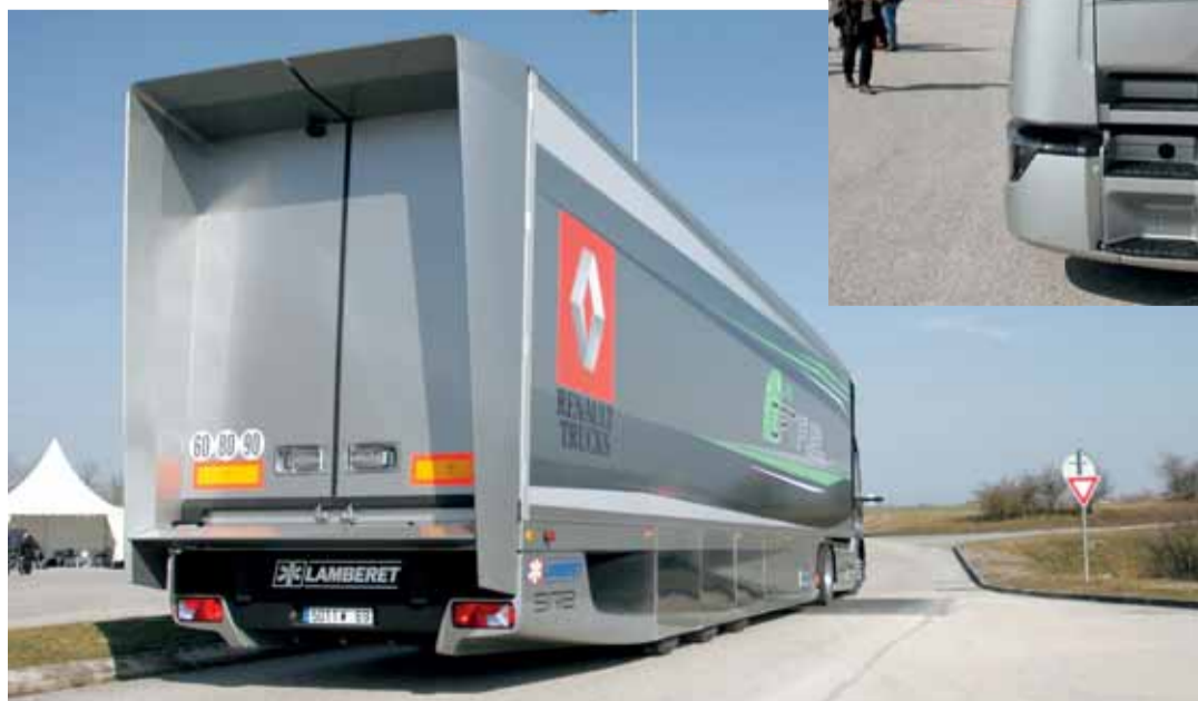
13 Prozent geringerer Spritverbrauch: Optifuel Lab von Renault Trucks unter anderem mit Sideflaps.
