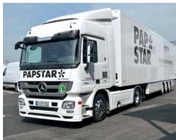
Im Test: Zugmaschine mit optimierten A-Säulen und verkleidetem Koffer im Werkverkehr von Papstar.
