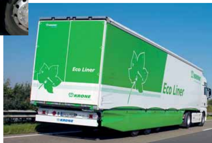
Serienreif: Der Krone-Ecoliner ist ein Curtainsider mit Vollverkleidung.
