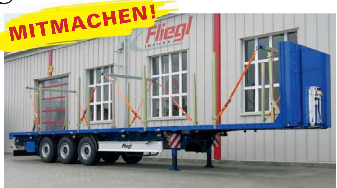
Plateaufauflieger mit Steck- und Schiebe-Rungen sollen das Verladen von Stahlmatten erleichtern und gleichzeitig die bestmögliche Sicherheit beim Transport gewährleisten.
